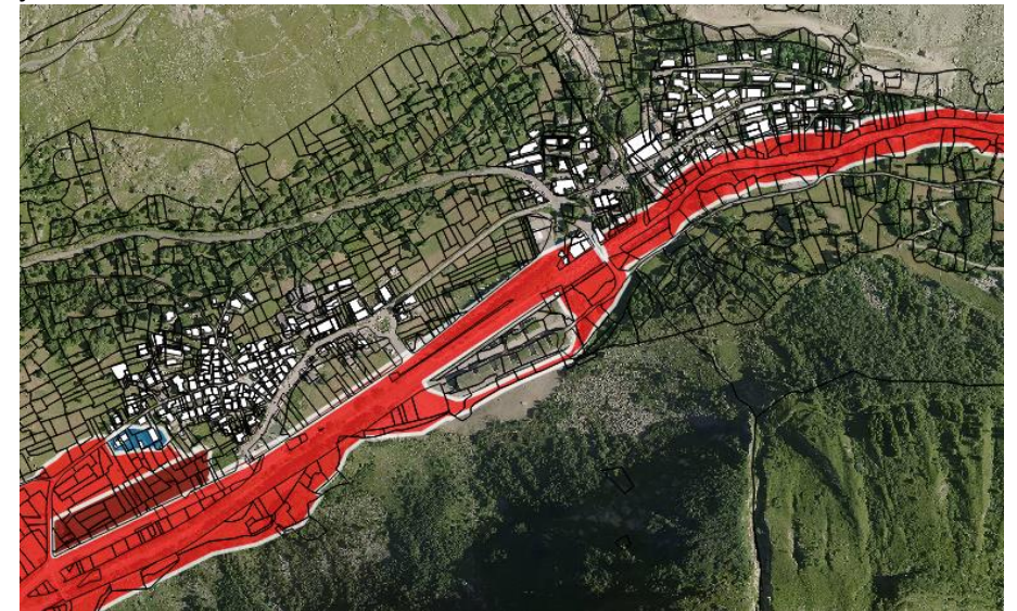
Risque inondation à Bonneval-sur-Arc – Traitement : Epode
